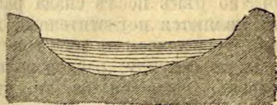
Поперечный разрѣзъ рѣки во время пониженія уровня; водяная масса на срединѣ ниже, чѣмъ у береговъ.
