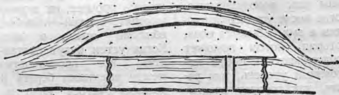
Перемычки и водоотводный канал.
