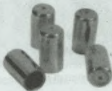
Электроды для воздушно-плазменной резки ЭЛ-03
